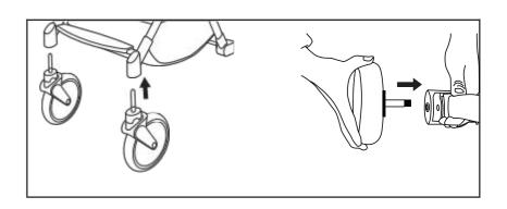
3. Вставьте вертикальную ось переднего колеса в соответствующее отверстие, как показано на рисунке, установите два передних колеса. Проделайте тоже самое с задними колесами.
