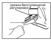
8. Отрегулируйте угол спинки, как показано на рисунке, зажав регулировочную пряжку и потяните.
